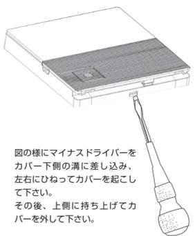
図の様にマイナスドライバーをカバー下側の溝に差し込み、左右にひねってカバーを起して下さい。その後、上側に持ち上げてカバーを外して下さい。
